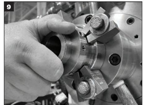
**WICHTIG: Um sicherzustellen, dass der Dichtungsflansch korrekt über der Hülse zentriert ist, die Welle von Hand drehen, damit sich die Dichtung frei dreht. Wenn in der Dichtung Metall-Metall-Kontakt hörbar/spürbar ist, ist sie falsch zentriert. Zum erneuten Zentrieren:**
