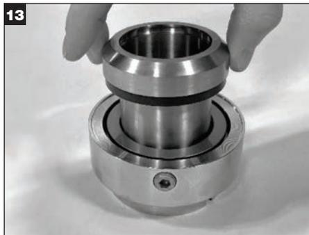
Die Hülsebaugruppe umdrehen und in die Dichtungsflanschbohrung einsetzen.
