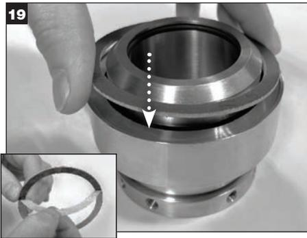
19 Die Klebstoff-Schutzfolie von der Dichtungsflansch-Flachdichtung abziehen und diese in der Ausnehmung im Dichtungsflansch anbringen.
