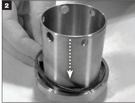
Eine dünne Schicht durchsichtiges Schmierfett auf den Gegenring-O-Ring (W) auftragen und diesen in der Nut montieren.
