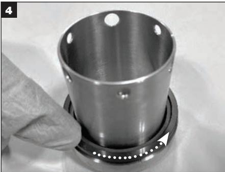
Die Gegenringfläche mit einem zugelassenen Lösungsmittel und einen fusselfreien Tuch reinigen.
