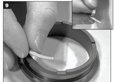
Die Schutzfolie vom Dämpfer abziehen und den Dämpfer zwischen den Mitnehmersprungs-Schlitzen anbringen. Sicherstellen, dass die Dämpferenden gleichmäßig in die Mitnehmerschlitze überstehen.
