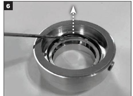
Den O-Ring (X) aus der Nut des Dichtungsflansches entfernen und entsorgen.
