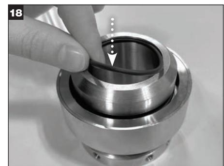
Eine dünne Schicht **durchsichtiges** Schmierfett auf den Wellen-O-Ring (V) auftragen und diesen in die O-Ring-Nut im Hülseinnendurchmesser einsetzen.
