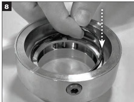
Eine dünne Schicht **durchsichtiges** Schmierfett auf den Gleitring-O-Ring (X) auftragen und diesen in der Nut im Dichtungsflansch über der Mitnehmerplatte montieren.
