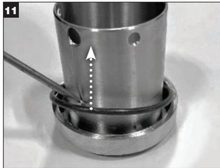
Den O-Ring (W) aus der Nut der Hülse entfernen und entsorgen.
