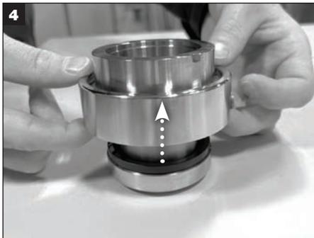
Die Hülse vom Dichtungsflansch trennen und die Hülse zur Seite legen.
