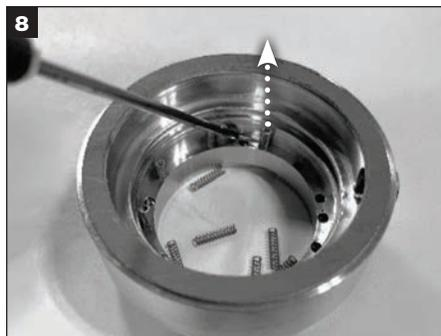
Alle Federn aus den Klemmringlöchern entfernen und entsorgen.
