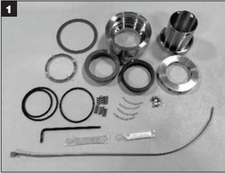
Zum Zusammenbau der Dichtung erforderliche Werkzeuge: Sechskantschlüssel und zwei Sorten Schmierfett (mit Dichtung mitgeliefert); fusselfreies Tuch, Pinzette und dicker Stift (vom Kunden bereitgestellt; zum Einbau der O-Ringe). Alle Metallteile mit einem zugelassenen Lösungsmittel, einschließlich alle Dichtungen und O-Ringflächen, reinigen. Die Metallkomponenten und alle Komponenten der Ersatzdichtung auf eine saubere, trockene Fläche legen.
