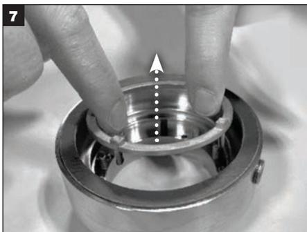
Die Mitnehmerbaugruppe aus dem Dichtungsflansch ausbauen und zur Seite legen.
